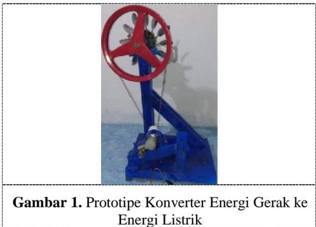
**Gambar 1.** Prototipe Konverter Energi Gerak ke Energi Listrik
